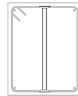
Beispiel 6: Kompaktquerschnitt (Balken bzw. Plattenbalken)
